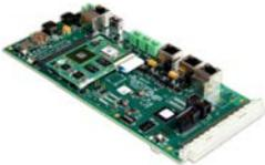
作为一个独立的控制器, MACC02可以替代控制系统中的PC, 以降低成本, 也可以配置与PC协同工作, 由MACC2处理实时性和时延要求高的任务, 如运动控制; 由PC处理时延要求不高的任务, 如HMI。
